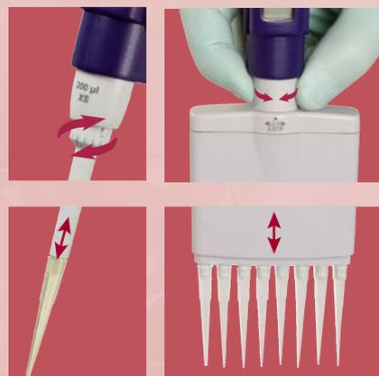
L'estremità dell'espulsore a forma di arco nei modelli multicanale consente l'espulsione sequenziale precisa del puntale.
